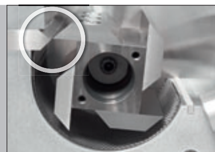
Starker PULVERISETTE 15 Schneid- rotor mit 4 geraden Schneiden
