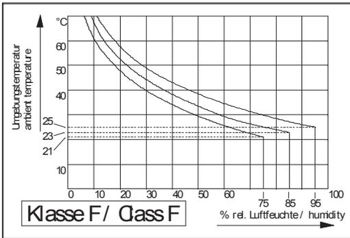
Für Kondensatoren mit dichtem Metallgehäuse sind zeitweilig oder auch dauerhaft höhere Luftfeuchten ohne Einschränkung der Lebensdauererwartung zulässig, solange eine Betauung der Anschlussklemmen sicher ausgeschlossen wird.
