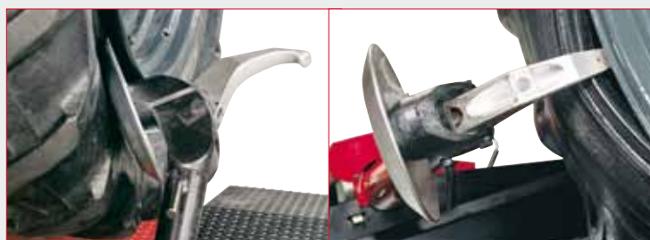
fase di stallonatura pneumatico tyre grooving phase
