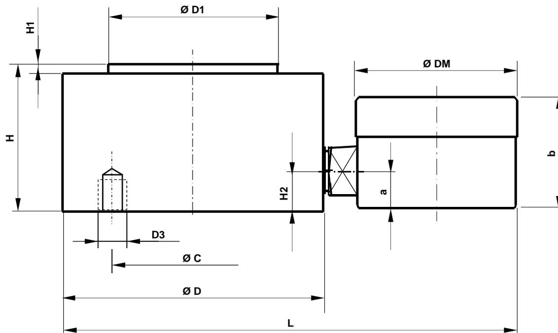
**Hinweis:** Dichtende Verschraubungen des hydraulischen Kraftaufnehmers dürfen nicht gelöst werden!
